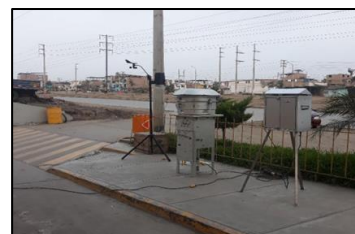
Equipos de monitoreo para la calidad de aire
