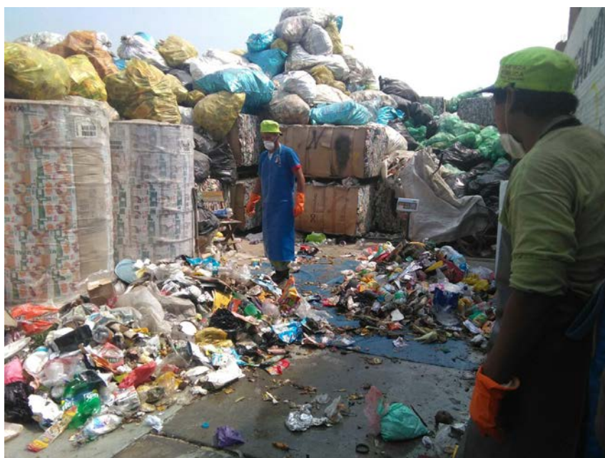
IMAGEN N° 26 APLICACIÓN DEL METODO DEL CUARTEO A LAS MUESTRAS DE RESIDUOS SÓLIDOS MUNICIPALES
