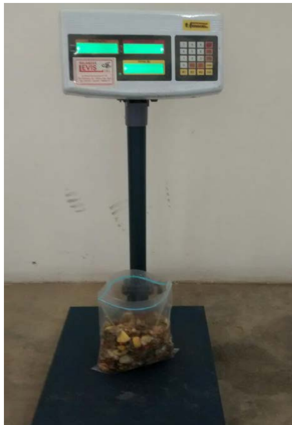
IMAGEN N° 20 BALANZA DE 100 KG. UTILIZADA PARA EL PESAJE DE MUESTRAS DEL ECRSM 2016
