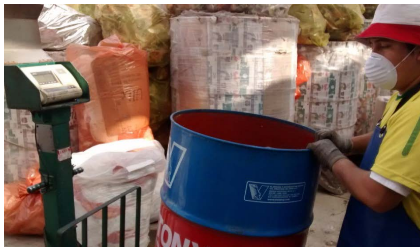
IMAGEN N° 29 PESAJE DEL CILINDRO CON LOS RESIDUOS SÓLIDOS
