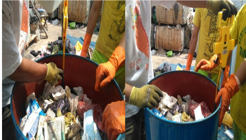
IMAGEN N° 28 MEDIDA DE LA ALTURA LIBRE DEL CILINDRO
