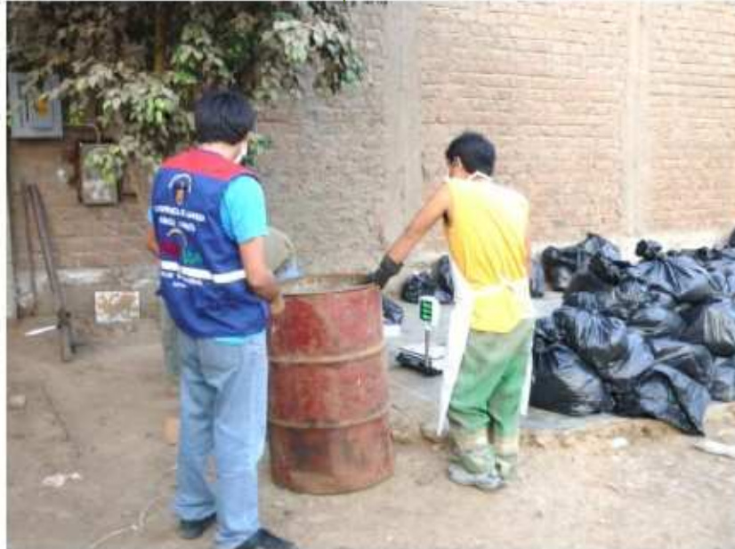
Ilustración N° 14: Selección de cilindro para la medición de la densidad
