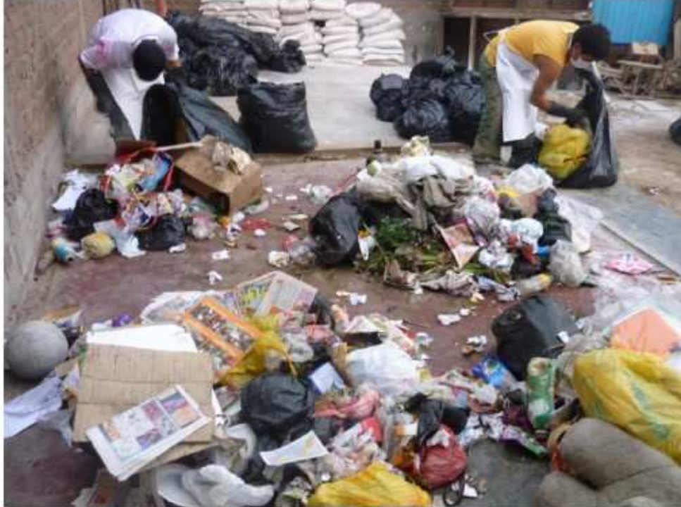
Ilustración N° 13: Cuarteo de residuos sólidos para la determinación de composición
