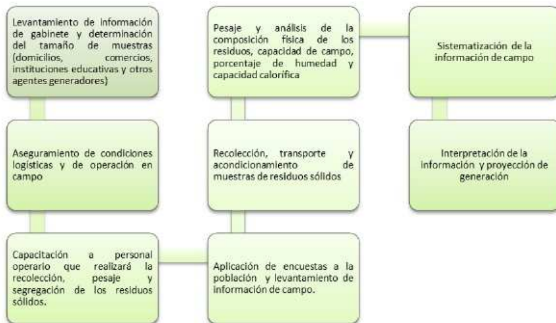
Ilustración N° 7: Secuencia lógica de intervención para la realización del Estudio de Caracterización de Residuos Sólidos
